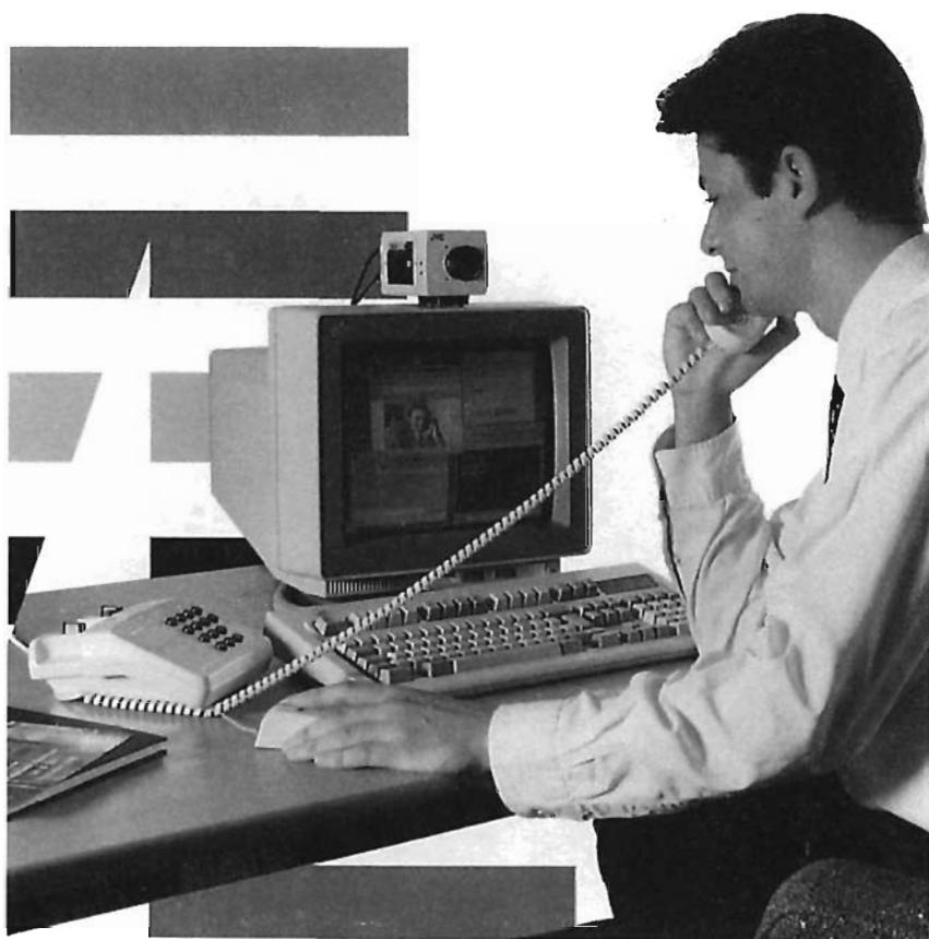
IBMs system "Person to person" — exempel på hur en persondator (eller arbetsstation) kan användas som bildtelefon.
